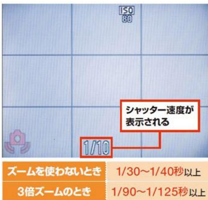
図4 画面に表示されるシャッター速度に注目しよう。ズームを使わないと
